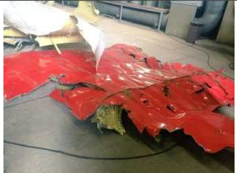
Höchstwahrscheinlich Unterseite des Heckteils. Dort ist der rote Streifen am breitesten. Auffällig die grossen, länglichen Einschläge, teilweise scharf unrissene Rechtecke. Die Ränder nach innen gedrückt.
