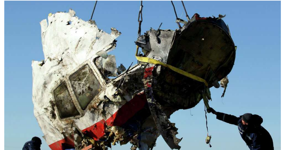
Die rechte Cockpitseite wurde von vielen Einschlägen zerstört. Oberhalb des Fensters sieht man mehrere Paralleleinschläge eines kleinen Kalibers.
