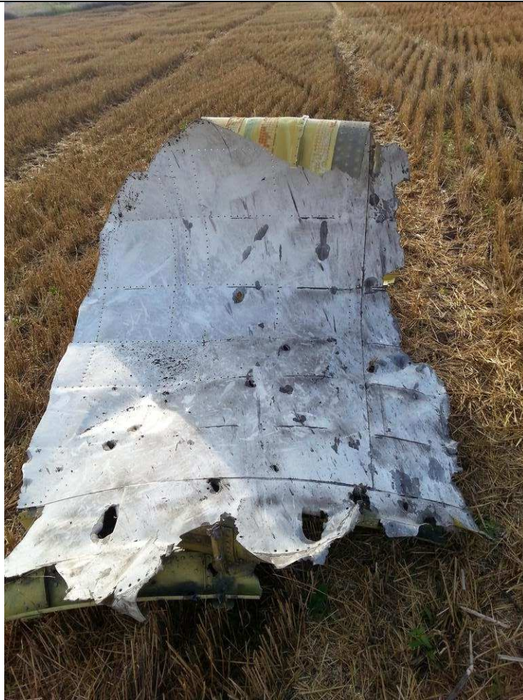
Teil des Cockpit, Einschläge in Richtung Fenster; Kleine und grosse, aufgerissene, Einschläge (links: längliche form)
